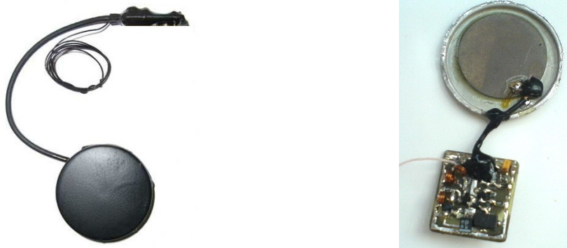
Рис. 1.10. Примеры радиостетоскопов с автономным питанием
