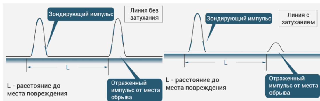
Рис. 6.2. Рефлектограммы проводной линии с разрывом
