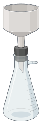
Фильтрование на воронке Бюхнера
